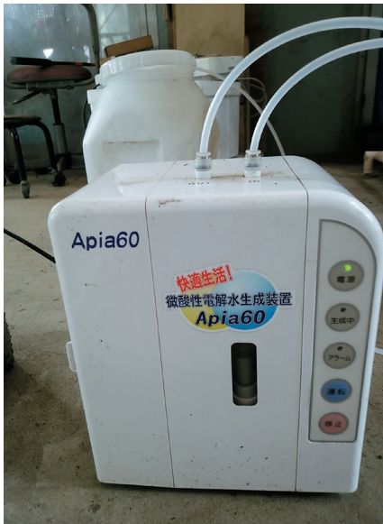
図6 次亜塩素酸水製造装置
