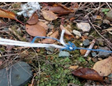
図34 違う品質のラインをつないで使用している例。接続部分でスパークが発生しやすく、ラインの損耗につながる
