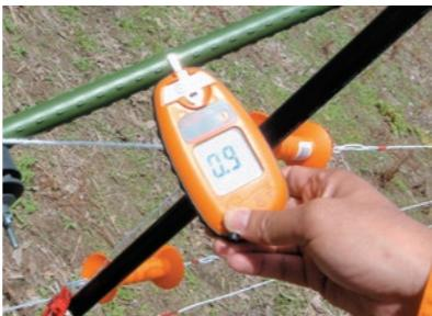
図20 ビニールで被覆されている園芸ポールも中が金属なので、ラインに接触すると漏電が起きる(この場合は900Vが逃げている)
