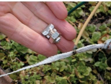
図35 パワーユニットから本線への接続が不適切な例。スパークが発生しラインの損耗につながる。写真のような専用の接続器具を用いる必要がある
