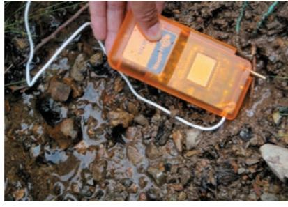
図14 アース棒の設置が適切だとアースにかかる電圧はほぼ0Vになり、電圧が表示されなくなる。定期的なアース電圧のチェックが必要である
