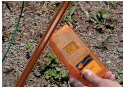
図12 アース棒の設置が不適切で2200Vが流出している
