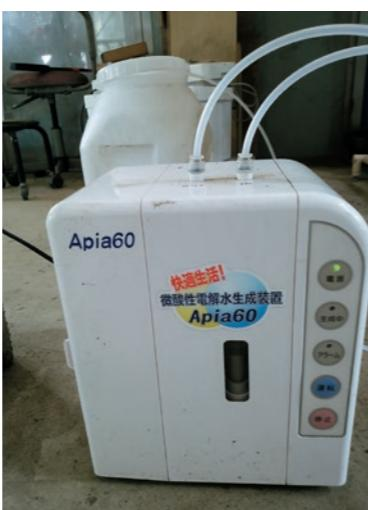
図6 次亜塩素酸水製造装置
