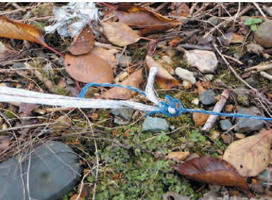
図36 違う品質のラインをつないで使用している例。接続部分でスパークが発生しやすく、ラインの損耗につながる
