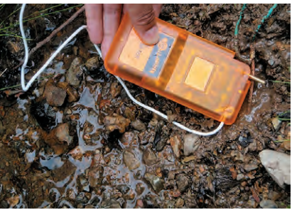
図16 アース棒の設置が適切だとアースにかかる電圧はほぼ0Vになり、電圧が表示されなくなる。定期的なアース電圧のチェックが必要である
