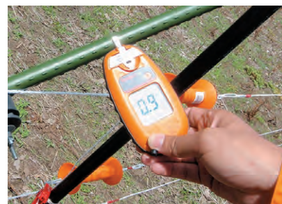
図22 ビニールで被覆されている園芸ポールも中が金属なので、ラインに接触すると漏電が起きうる(この場合は900Vが逃げている)
