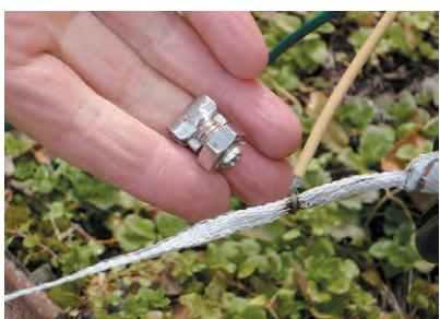
図37 パワーユニットから本線への接続が不適切な例。スパークが発生しラインの損耗につながる。写真のような専用の接続器具を用いる必要がある
