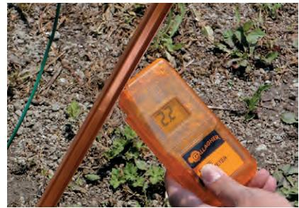
図14 アース棒の設置が不適切で2200Vが流出している
