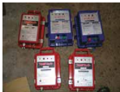
電気柵用のバッテリー。
