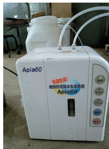
図6 次亜塩素酸水製造装置 小型の装置でも1分間に1Lの次亜塩素酸水の製造能力があるが、処理能力の大きなものも複数メーカーから販売されているので、経営規模に応じた装置選択が可能である
